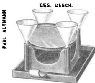
In dem Kasten eines Schlittens, der mittels Schienen fortbewegt und auch auf die horizontal herumgelegte Verschluss- klappe des Trockenkastens herausge- zogen werden kann, befinden sich vier Hülsen, in welchen die Trichter durch Neusilber-Federn festgehalten werden können. Das in der Mitte der Decke in einem seitlich durchlochtem Conus be- festigte Thermometer kann so tief in den
